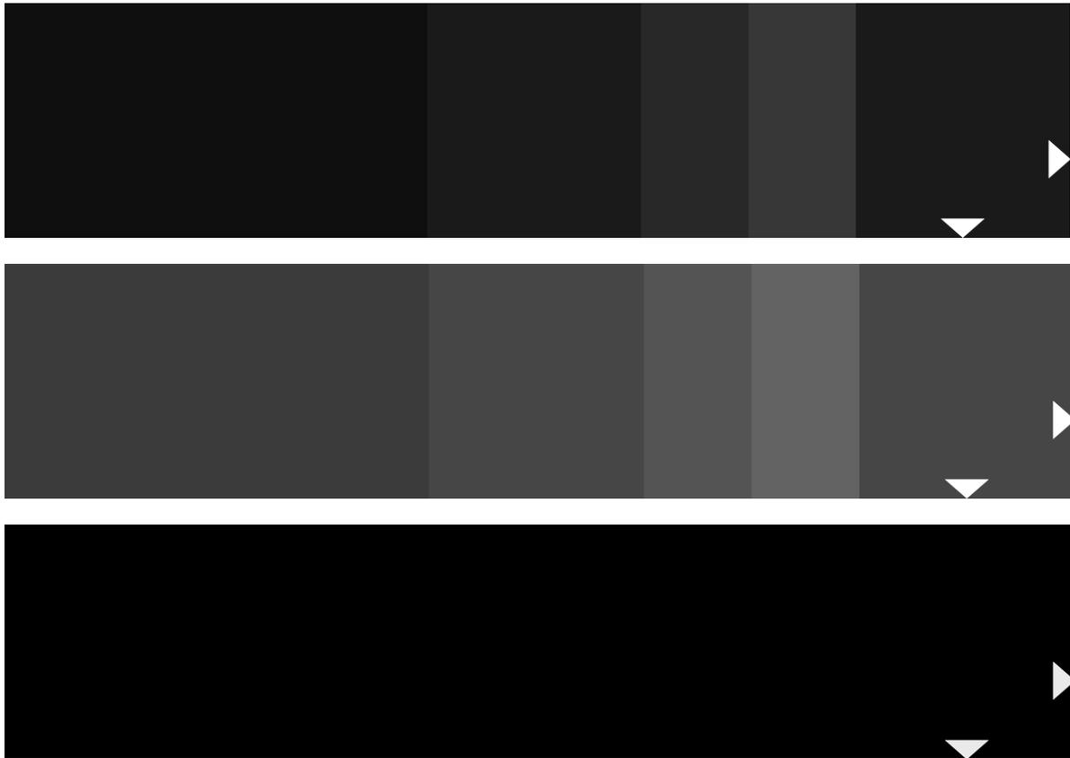
**Abbildung 6.2.2.2** – **Oben:** Hier ist die Helligkeit für Extended Range richtig justiert. Der Balken 3 ist minimal dunkler als der Balken 4 und die restlichen Balken 5 und 6 sind etwas heller.
