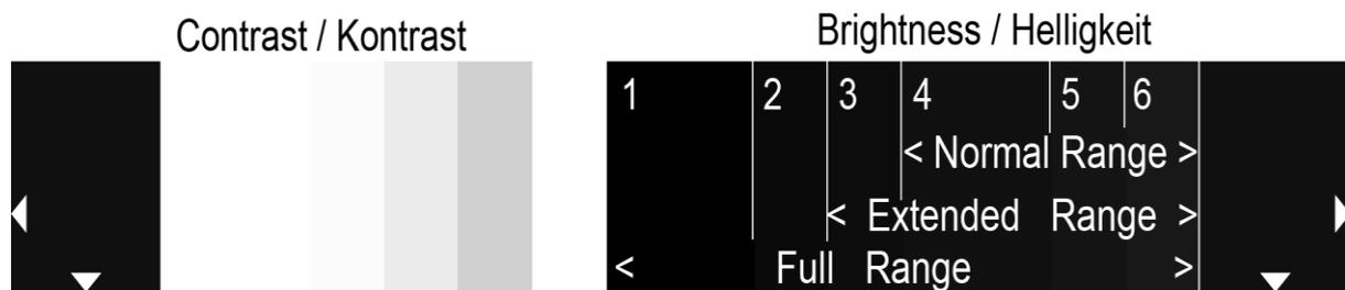
**Abbildung 6.2** – Der untere Bildbereich des Testbilds zum Einstellen der Helligkeit. Die Balken 1 - 6 sind für die Abbildung extra hervorgehoben (Trennlinien). Je nach Video Range sehen Sie eine ähnliche oder andere Darstellung. Siehe vorheriges Kapitel. Der darstellbare Video Range entscheidet welche Balken für Sie beim justieren der Helligkeit ausschlaggebend sind.
