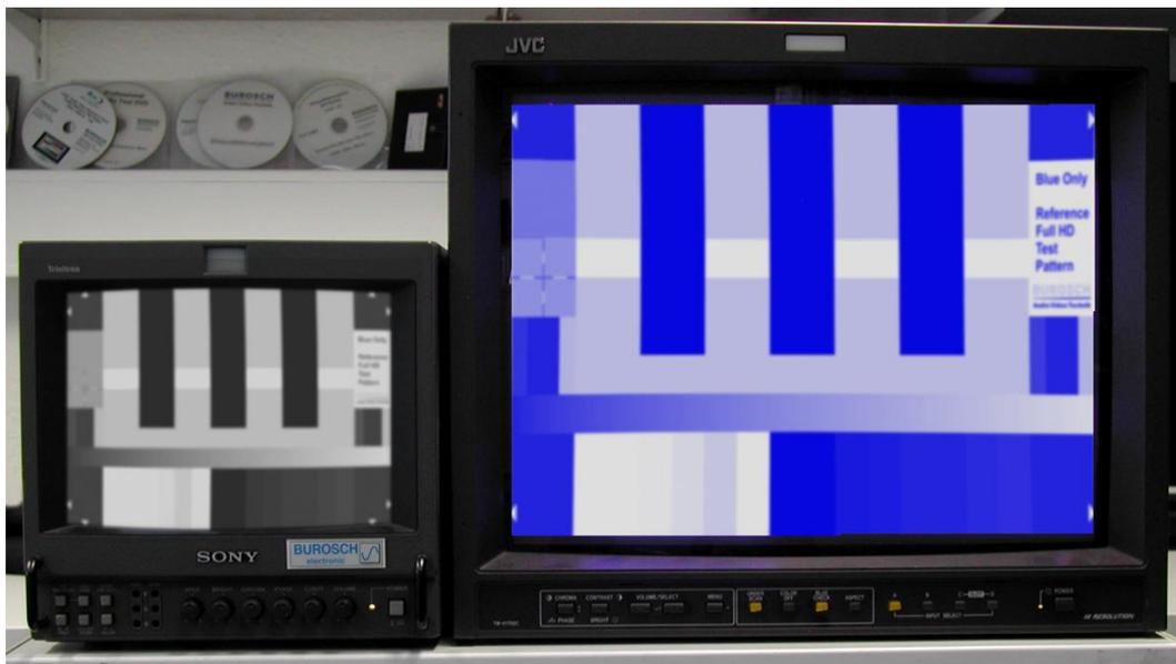
Abbildung 8.2 – Das Blue Only Testbild auf zwei SD Röhrenmonitoren.
